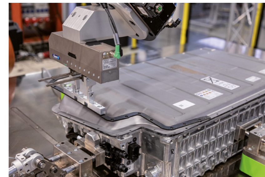
Im Projekt ist vielfältige Hardware für die automatisierte Demontage entstanden, so beispielsweise dieser Kleinteilegreifer.
